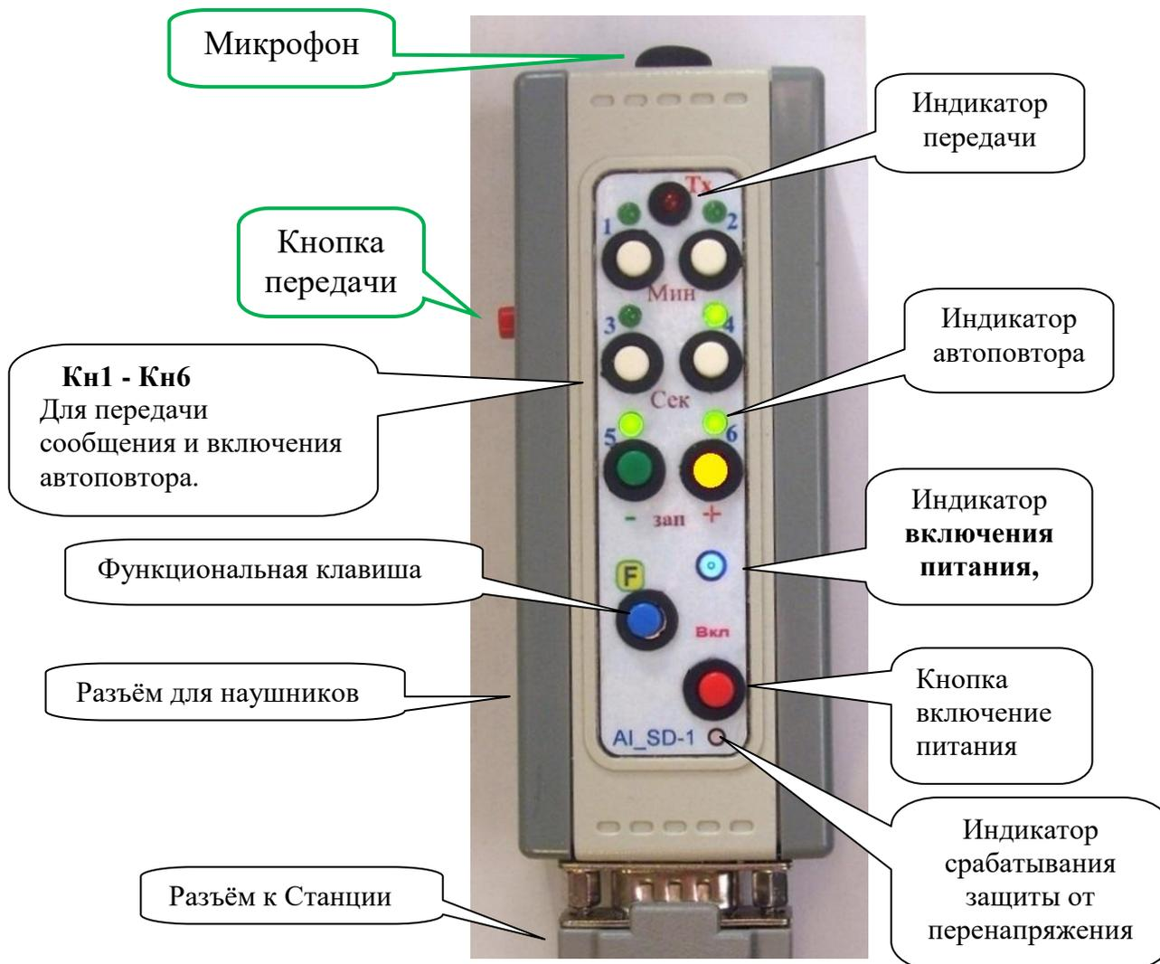
Рис 3. Органы управления и индикации автоинформатора
